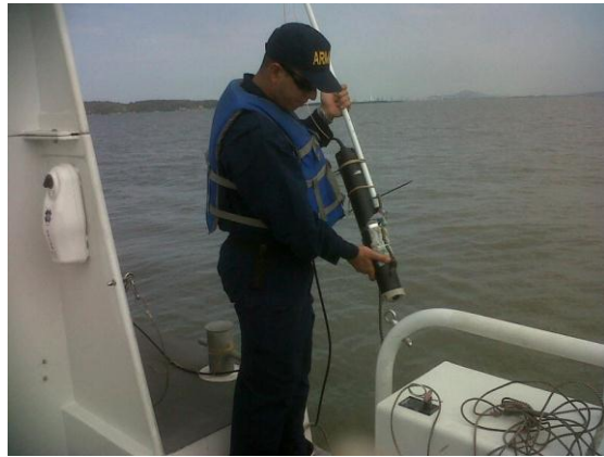
Imagen 3 Toma datos de corriente utilizando el ADCP Aqua Pro
