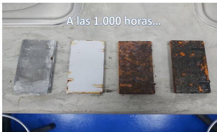
Figura 3: Probetas con los distintos recubrimientos al cabo de 1.000 horas en la cámara. Fuente: (Propia)
