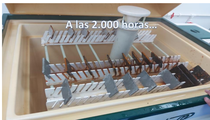
Figura 4: Probetas al cabo de 2.000 horas en la cámara de niebla salina. Fuente: (Propia)
