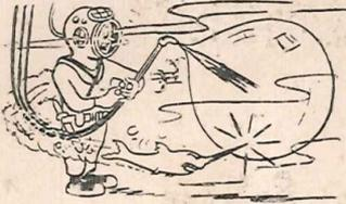
Un sistema cortante más nuevo y eficiente es el soplete oxieléctrico. Este moderno instrumento utiliza un electrodo de acero hueco. Un arco eléctrico formado entre el electrodo y la pieza de acero a cortar. Oxígeno a alta presión pasa a través del interior del electrodo y es arrojado al área incandescente del arco eléctrico, provocando la oxidación instantánea del acero.
