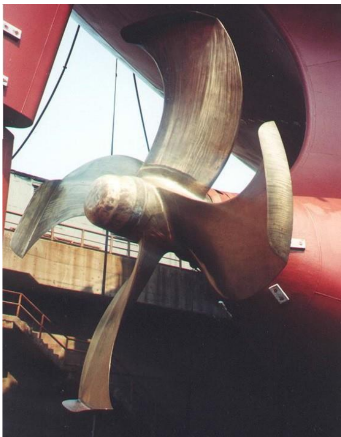
Figura 1. Hélice CLT instalada en el bulkcarrier “Paiute”
