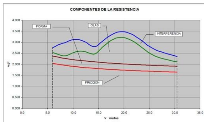
Figura 8. Componentes de la resistencia Fuente: CEHIPAR
