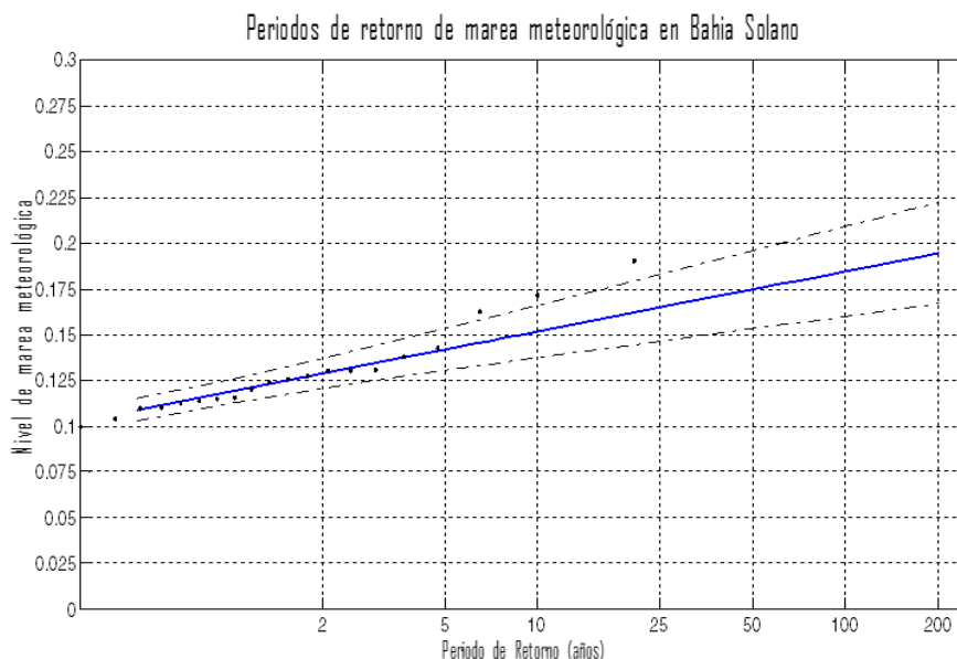
Figura 16. Regímenes extrémales de la marea meteorológica modelada en Bahía Solano. Fuente: Propia; Matlab
