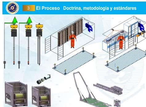
**Figura 3.** Componentes del sistema para la recolección de muestras de sedimentos submarinos.
